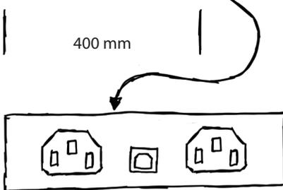
Angeschlossen wird die Bargeldeinheit mit dem mitgelieferten Kaltgeräte-Y-Kabel und dem USB-B Kabel vom Terminal.
