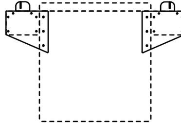
Setze die Gewindeschrauben M6 in die bereits vorhandenen Löcher am Boden des Kühlgerätes ein. Für die drei Löcher in der Deckelplatte verwende bitte die Selbstschneideschrauben.
